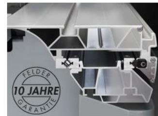
El perfil de la mesa deslizante de formato con sus 5 cámaras y la base sólida le dan a la mesa deslizante una enorme resistencia a la flexión y torsión.
