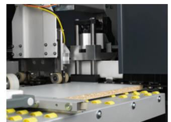
**3.3 KW (S1) eje de fresado ER 32, 24.000 rpm**
